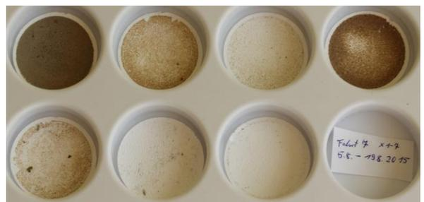
**Eine Probenserie besteht normalerweise aus sieben Wasserproben. Die Fotografien der Filterserien zeigen große Unterschiede in der Menge der Schwebstoffe pro Probe und ihren Eigenschaften wie Färbung und Konsistenz.**
