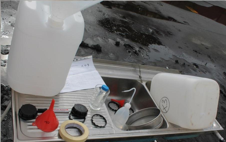
Die Seewasserproben werden in 20 l Kanistern abgefüllt. Um die Schwebstoffe in den Seewasserproben untersuchen zu können, wird das Wasser zuerst durch ein sehr feines Sieb mit einer Porengröße von nur 63  $\mu\text{m}$  vorgefiltert. Dieser Schritt kann direkt im Hamburger Hafen durchgeführt werden.
